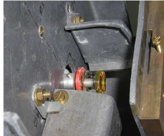
Quelle und Quellschieber
