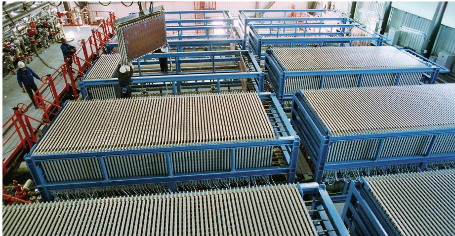
Montage der Module eines bipolaren Uhde BM 2.7 Elektrolysierr
